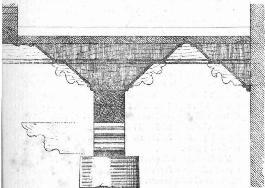
Fig. 19. — Sezione trasversale d'un soffitto (1 a 25).
