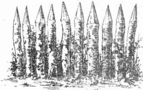
FIG. 3. — Palizzata (1 a 50).
