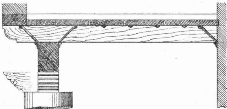
FIG. 27. — Sezione di un soffitto (1 a 40).
