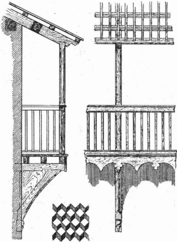
FIG. 63. — Particolare di un ballatoio (1 a 50).
