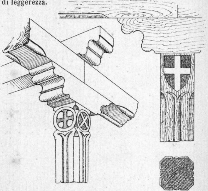
FIG. 145. — Particolari di travature in legno.
