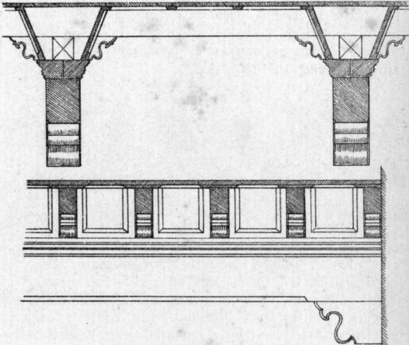
FIG. 153. — Particolari di costruzione di un soffitto (1 a 25).
