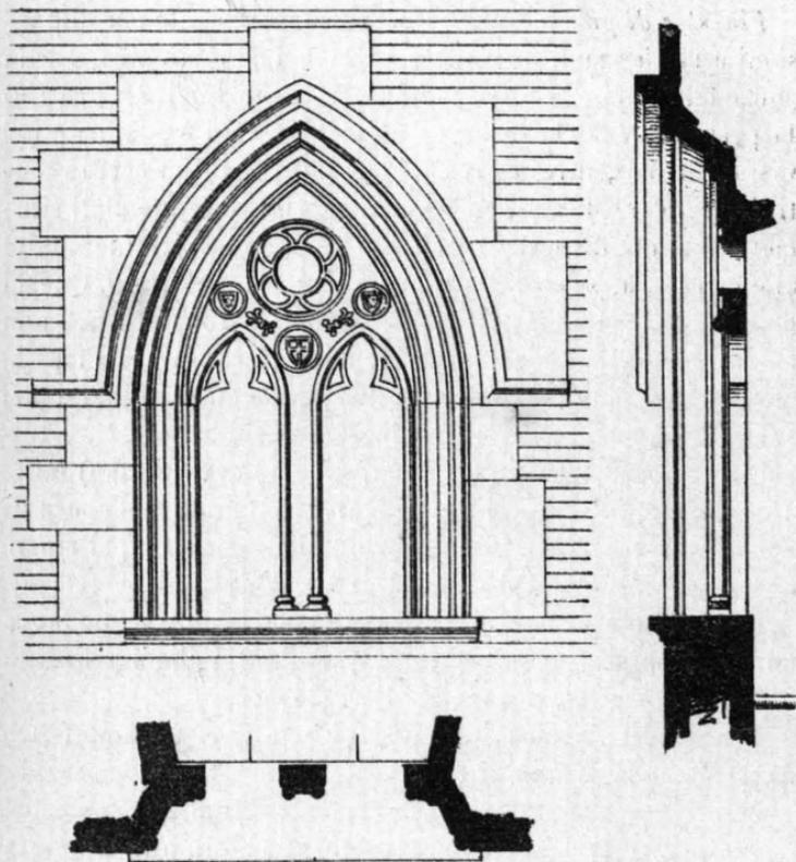
FIG. 130. — Finestra unica nell'antisala (1 a 50).
