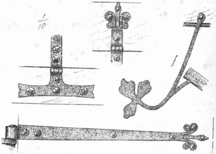
FIG. 22. — Ferramenta di chiusura (1 a 10).
