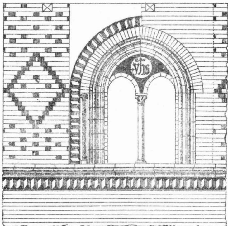
FIG. 31. — Finestra e decorazione del primo piano (1 a 50).
