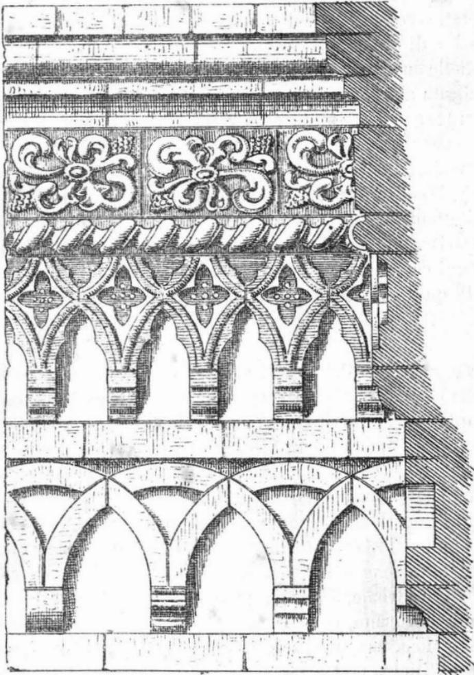
FIG. 67. — Cornicione di coronamento (1 a 10).
