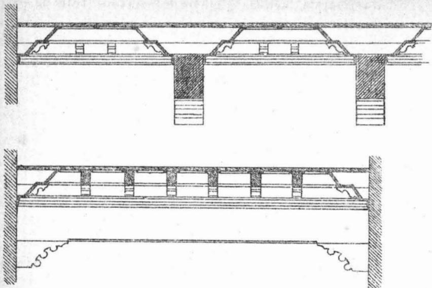
FIG. 46. — Sezioni di un soffitto (1 a 50).
