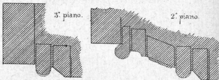
FIG. 93. — Sezioni di stipiti di finestre (1 a 10).
