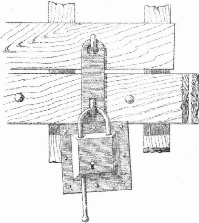
FIG. 37. — Serratura di un cancello (1 a 5).
