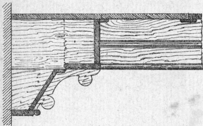
Fig. 73. — Particolare di un soffitto (1 a 10).
