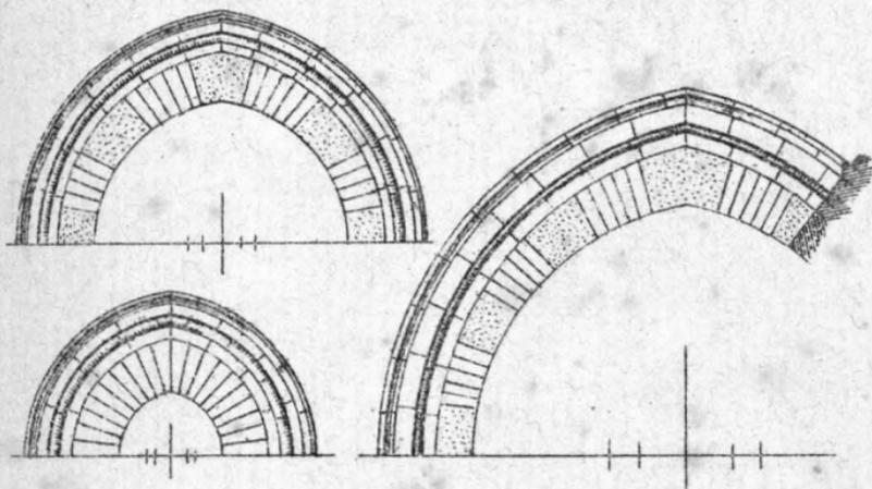
FIG. 98. — Archi delle finestre (1 a 50).
