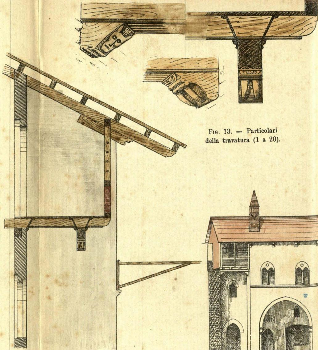
FIG. 13. — Particolari della travatura (1 a 20).
