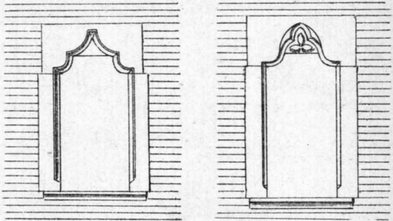
FIG. 136. — Finestre di secondo piano (1 a 50).
