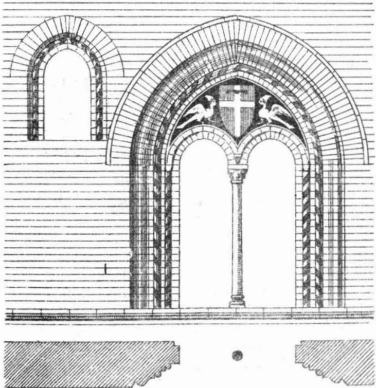
FIG. 41. — Finestra bifora e finestruola (1 a 50).
