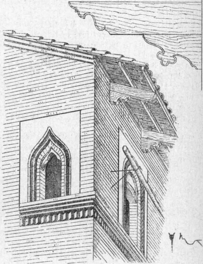
FIG. 95. — Finestra nel fianco; travatura.
